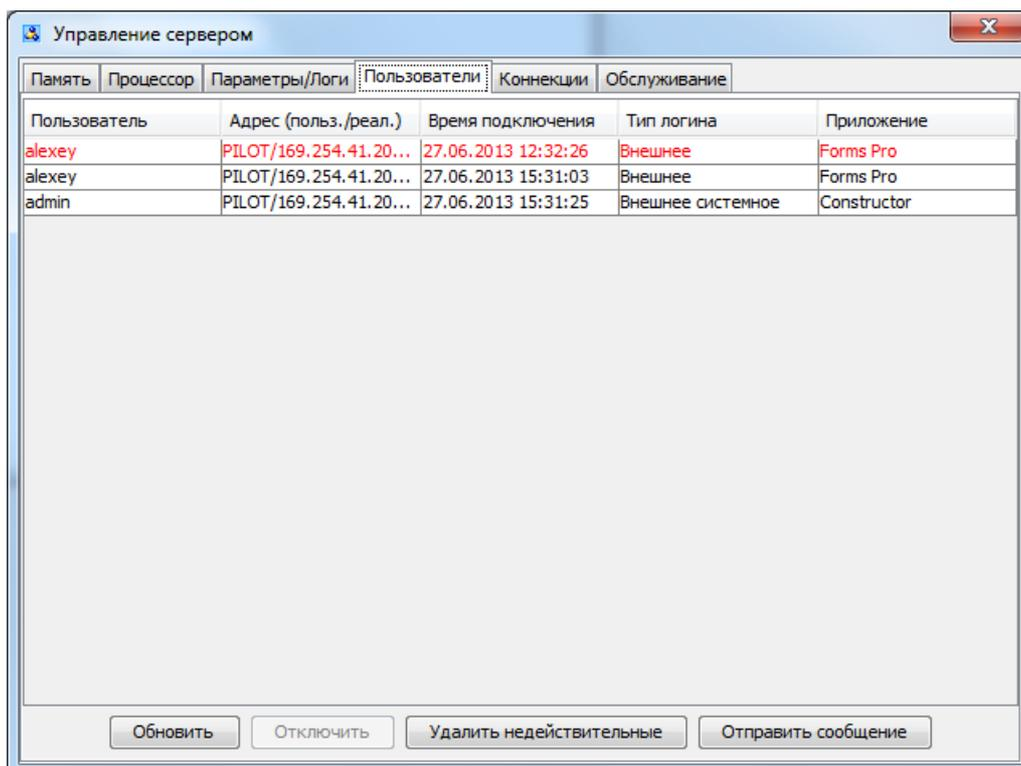
Сессии, помеченные красным, не прошли проверку, т.е. сетевое соединение с приложением, инициировавшим такую сессию, отсутствует. В редких случаях, когда проверку осуществить не удалось (например, из-за сетевых тайм-аутов, когда за некоторое время не удалось понять, оборвано ли соединение действительно), сессии помечаются фиолетовым.
