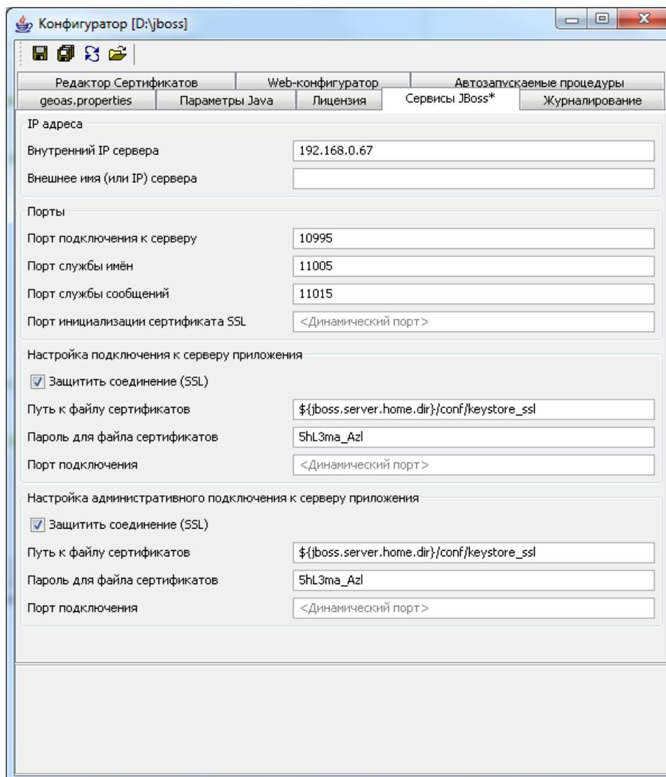
В первую очередь необходимо задать **«внутренний IP»**, т.е. адрес адаптера (сетевой карты), на котором сервер будет открывать порты для подключения. Если этот адрес не задать, будет использоваться 127.0.0.1, т.е. сервер будет доступен только в пределах того же компьютера.
