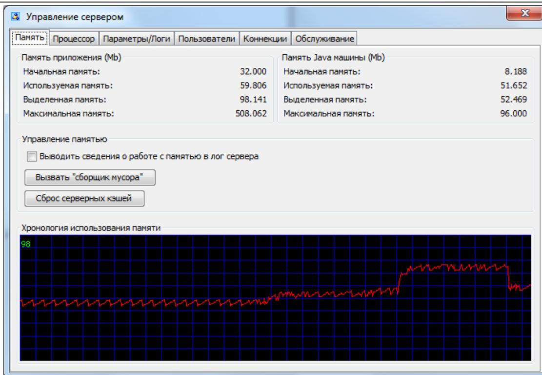
В верхней части находятся два блока, отображающих сведения об объеме памяти, занимаемой сервером внутри Java-машины. Память в Java-машине делится на доступную приложению (в данном случае, серверу GSEE, левый блок) и на служебную (правый блок).
