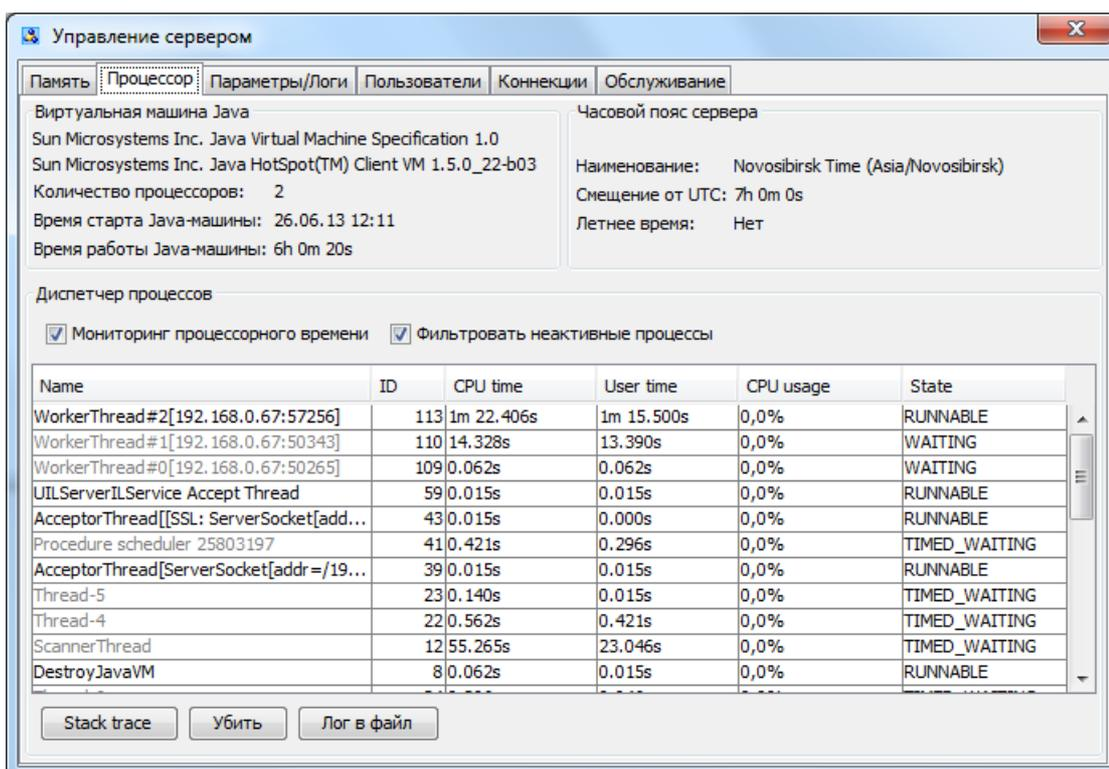
В верхней части вкладки находятся два информационных блока. Левый блок в числе всего прочего отображает наименование реализации Java-машины, что может быть полезно разработчикам при отладке. В правом блоке отображаются сведения о часовом поясе, как он настроен для сервера GSEE.
