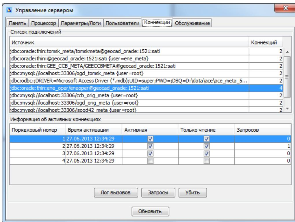
В верхней части вкладки отображается список описаний подключений. При выборе одного из элементов списка в нижней части вкладки отображаются сведения о коннекциях, взятых по этому описанию.
